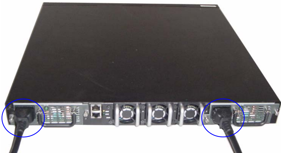
Figure 2. Branchement des câbles d'alimentation
