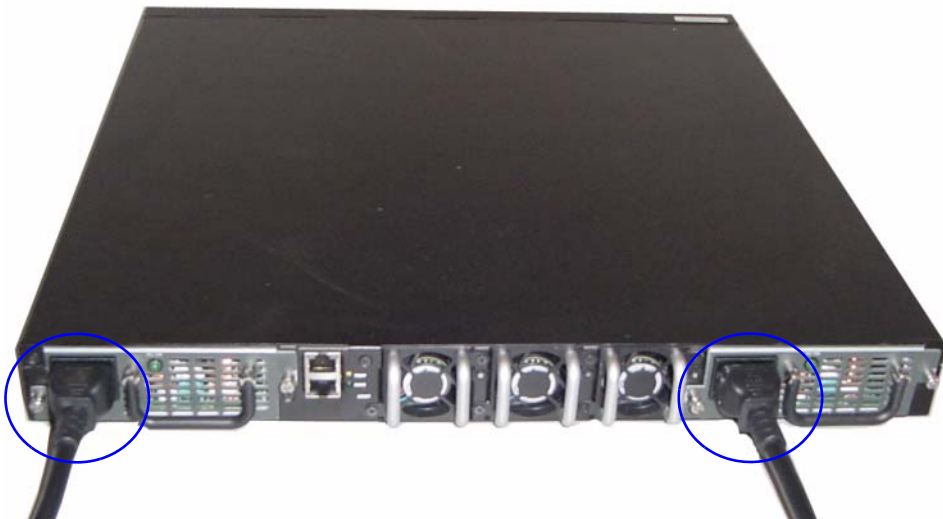
Ilustración 2. Conexión de los cables de alimentación
