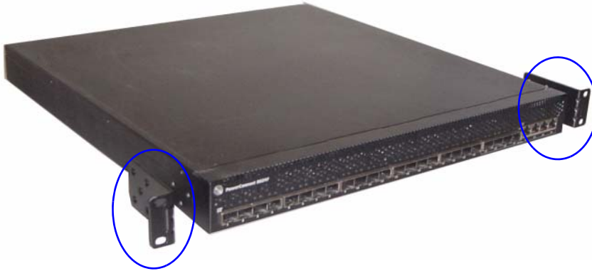
Ilustración 1. Fijación de los soportes
